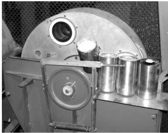
Рис. 3. Общий вид мельницы ПМ-1 с футерованными барабанами, с опциями быстрой загрузки–выгрузки материала и независимого вращения барабанов и диска.
